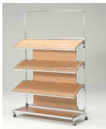
■シェルフMR W1200×D500×H1400 (71280) アーチ:H450 仕様: スチール / クロームメッキ 背板・棚 / スチールクローム枠付き木製化粧板 (モクメ)
